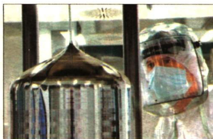
Vorstufe der Wafer (Grundplatten): Das Silizium, das erzeugt wird, wenn Polysilizium geschmolzen und in einem Ofen kristallisiert wird, nennt sich Ingot. Dieses zylindrische Stück wird später in 0,18 bis 0,28 mm dicke Scheiben, die Wafer, gesägt.
