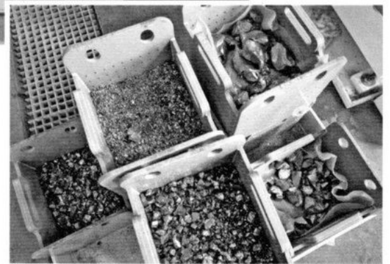
Graues Gold: Mitarbeiter des chinesischen Photovoltaik-Herstellers Trina Solar sortieren die Siliziumbrocken aus Fehlgüssen nach ihrer Größe, um das kostbare Rohmaterial anschließend zu recyceln.
