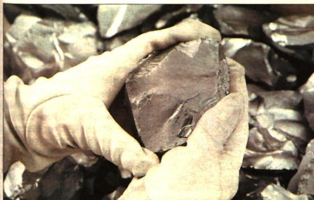
Bereit für die Schmelze: Nachdem das Silizium im Siemens-Reaktor zu Säulen gewachsen ist, wird es zur Weiterverarbeitung in kleine Teile gebrochen.
